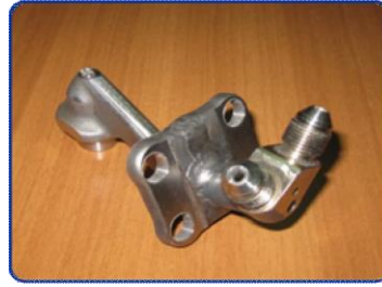
5-сурет Дәнекерленген және «өсірілген» отын бүріккіш
